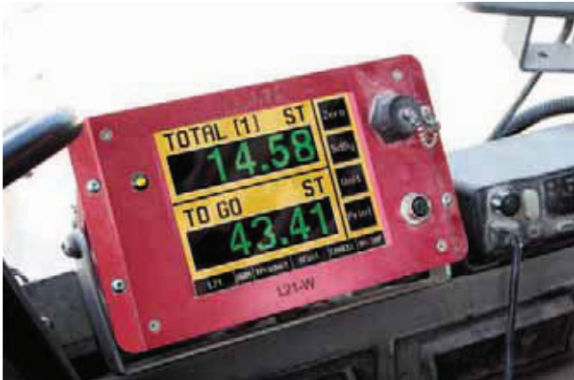
Système L21-W de pesage embarqué sur chargeuse, avec écran tactile TFT pour l'échange de données
